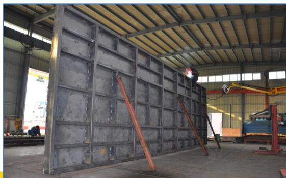
板下方全部用钢板焊接成网格状，使车架受力均匀。车轮分别安装在箱型梁的两端，有效的降低了台面高度。为方便吊装，在平车两侧设置了起吊孔。
