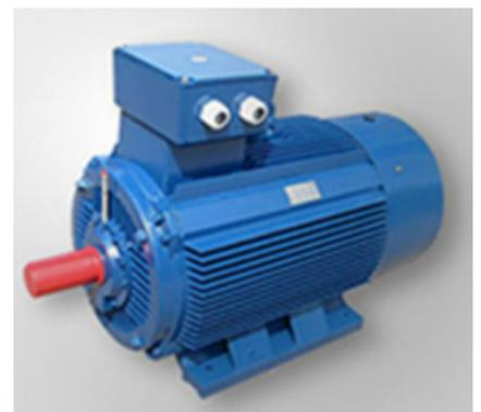
本系列电机采用 380V 电源，50Hz，基本工作制为 S4，负载持续率 25%，通电电动次数每小时 120 次。可适用于频繁起动、震动、冲击及过载的工况。
